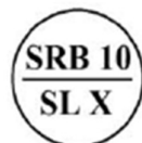
Слика 3. Жиг за накнадну уградњу граничника брзине, где „x” представља бројчану ознаку радионице
